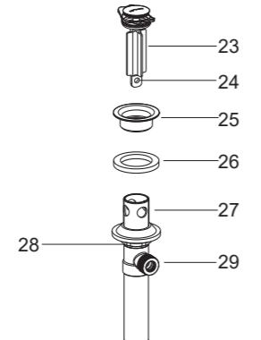
**注意：**如果需要，可直接在法兰盘(25)底面沿周围涂上一圈密封油灰，而不用垫片(26)。
