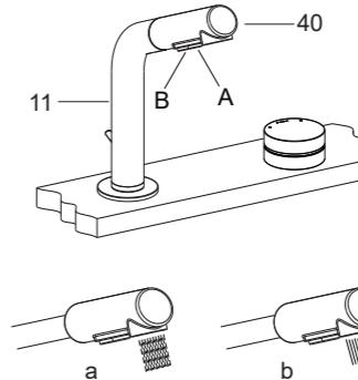
向上拉动出水口组件(11)可调整出水口高度。打开龙头，可得到水流(a)；按下图中(A)处，可得到水流(b)；按下图中(B)处，可关闭水流。
