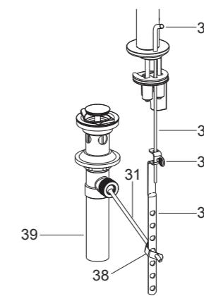
将提拉杆组件(35)插入到出水口后侧孔中，并穿过联杆(37)的孔。用V形夹(38)将联杆接在球动杆(31)上，把手捻螺丝(36)装到联杆(37)上。将球动杆往下推到排水器全开位置。调整提拉杆的高度，使提拉杆头(34)底部距离安装台面10mm左右。拧紧手捻螺丝。把尾管(39)连接到去水弯管上。
