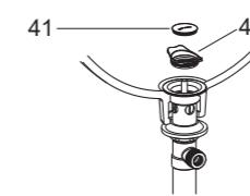
逆时针旋下排水器止水塞(41)，取出并清理滤网(42)。将滤网和止水塞重新装回。
